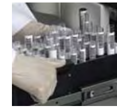
El SMS tiene cuatro cajones, cada uno con 50 tubos de muestra, para una capacidad total de 200 tubos.
