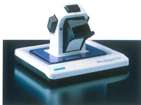
La configuración del sistema de inoculación PROMPT utiliza una asa plástica calibrada para crear un inóculo estandarizado sin ajustes de turbidez que requieren de mucho tiempo. Las suspensiones bacterianas se mantienen estables hasta por 4 horas. Use el RENOK para inocular y rehidratar simultáneamente los 96 pozos de los paneles MicroScan.
